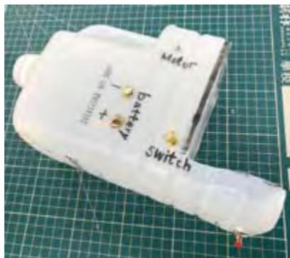
切割好，並加工放上電路接點，再用英語寫上 positive, negative, switch, motor 等接點名稱（如前圖），以利學生連接電路。完成 prototype 後，Mr. Conrad 接著寫出製作 Artbot 流程的簡易指導語，並自製以圖像內容為主的電路概念教學投影片，讓電路概念淺顯易懂。
